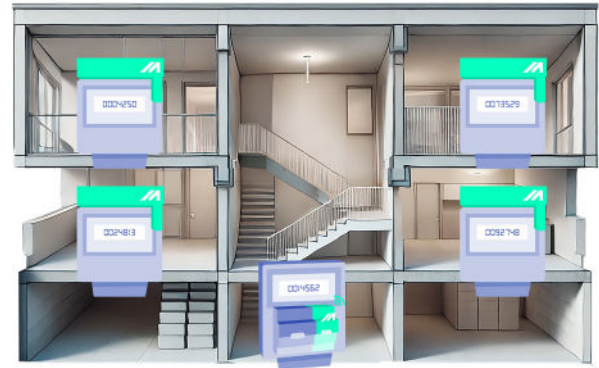
1:n Metering im Mehrparteienhaus – 5 Zähler an einem SMGW angeschlossen
